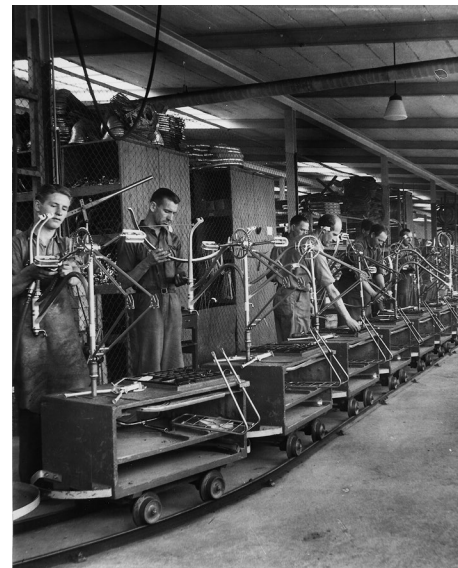
Slutmontering av cyklar i Monarkfabriken, 1950-tal. Foto: Monarkmuseets arkiv. Bilden är beskuren.
